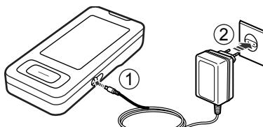
Для отсоединения адаптера переменного тока сначала выньте штекер адаптера переменного тока из электрической розетки, а затем немедленно отсоедините адаптер переменного тока от главного устройства.
