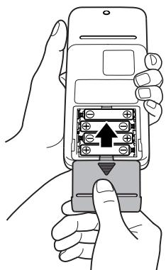
4. Установите на место крышку отсека для батарей. Задвиньте крышку, как показано на рисунке, до щелчка.
